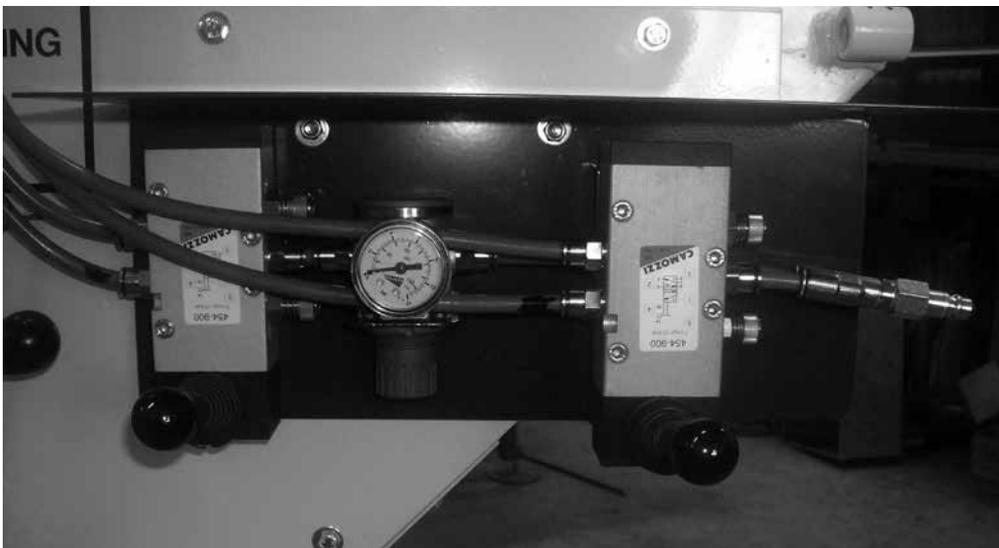
Der Luftdruck kann mithilfe eines Reglers auf einen passenden Wert (6 Bar) eingestellt werden. Die Steuerung der Zylinder erfolgt per Hebel. Nach oben bzw. nach unten
