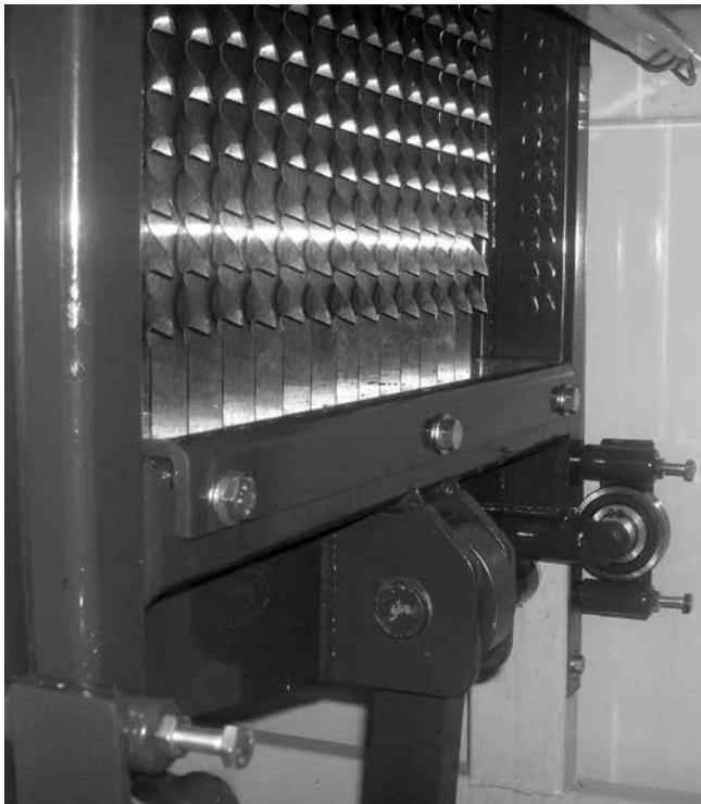
Eine Nocke an jedem Ende des Sägegatters bestimmt die Sägeholzabmessungen.
