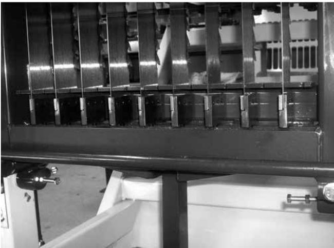
Auch die Schrauben für die Blätter an der Sägegatterunterseite müssen entfernt werden.
