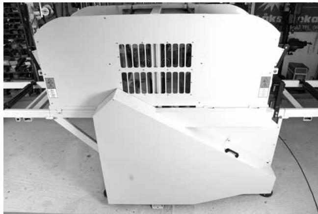
Schließen Sie das Stromkabel an und betreiben Sie die Säge testweise, um zu kontrollieren, ob sich der Elektromotor in die richtige Richtung bewegt (gemäß dem Pfeil auf dem Motor). Ist die Richtung nicht korrekt, sind die Pole des Anschlusskabels möglicherweise vertauscht. Vertauschen Sie die Pole.
