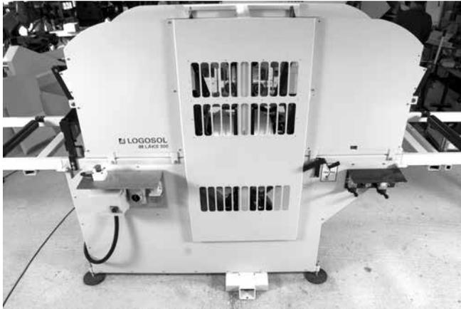
Montieren Sie die Schutzbleche auf beiden Seiten der Säge.
