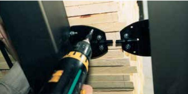
3. Oberes Visier nach der angerissenen Schnittlinie ausrichten und auf der Seite des Stapels, die nicht abgesägt wird, eine Schraube durch die Bohrung des Visiers schrauben.
