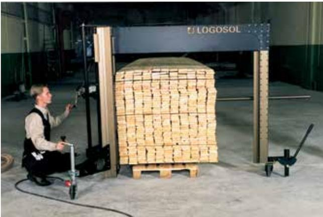
2. Winkel der Bundsäge mit Hilfe der Kurbel des höhenverstellbaren Rades grob einstellen.
