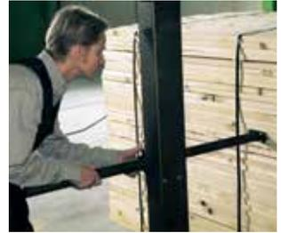
7. Kontrollieren, dass der Kunststoffstift, der die Position des Sägeschnitts anzeigt, möglichst horizontal liegt.
