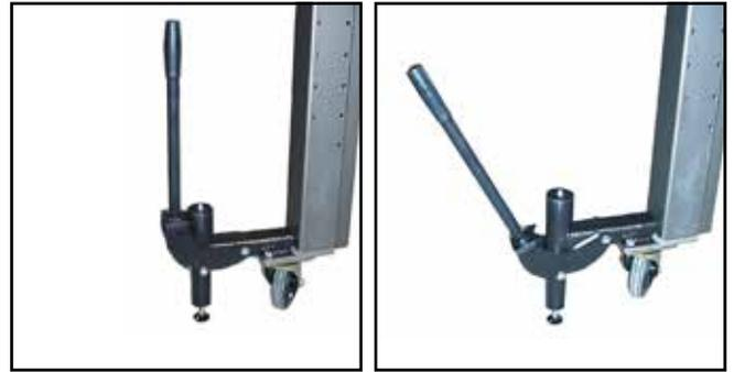
*Feststellstütze in angehobener und abgesenkter Stellung. Die verstellbare Stütze ist so einzustellen, dass die Bundsäge um ca. 5 mm angehoben wird. Zum Lösen der Stütze den Hebel nach oben ziehen.*
