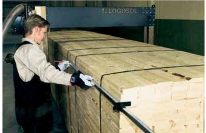
Anschlag an die Schnittfläche anlegen und die neue Sägelinie oben und unten an beiden Seiten des Holzstapels anreißen.
