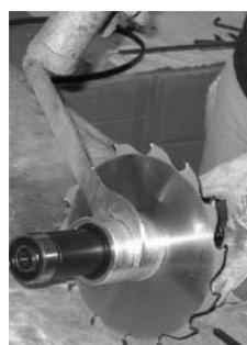
Sollte die Gewindemuffe zu fest sitzen, mit einem Kunststoff- oder Gummihammer auf den Riemenspanner klopfen. Dies geht einfacher, wenn die Messerwelle noch in der Maschine sitzt, lässt sich aber auch noch durchführen, wenn sie bereits herausgenommen wurde. Schutzhandschuhe tragen und auf einer hölzernen Oberfläche arbeiten, damit Messer und Sägeblatt nicht beschädigt werden.
