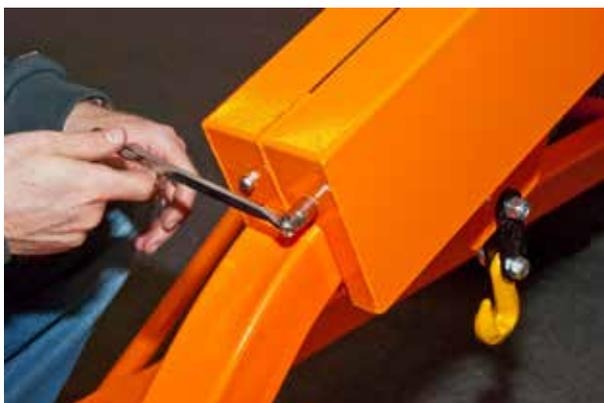
12. Setze die Abdeckung über der Gleitbahn mit der Vertiefung für den Rohrbogen nach hinten auf den Anhänger. Schraube die Haube mit **vier M6x16** inkl. **M6 Unterlegscheiben** fest.
