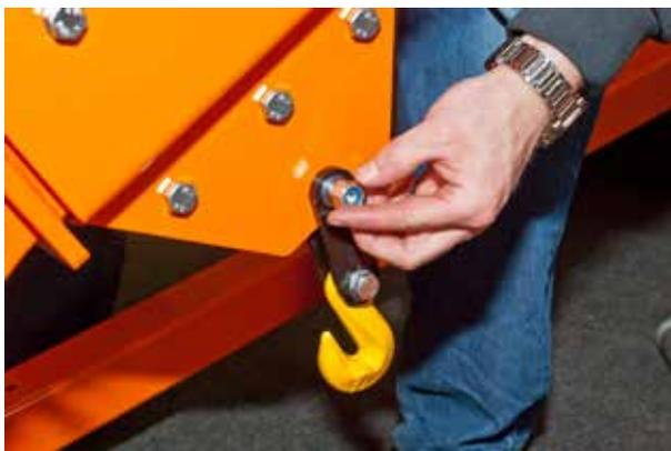
11. Montiere die Laschen und den Lasthaken auf dem Schlitten mit **2 x M10x40** einschließlich **M10 Kontermutter** und **M10 Unterlegscheiben**.
