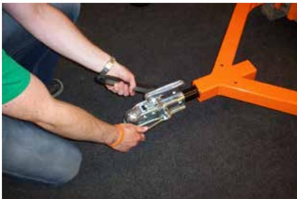
3. Stecke die schwarze Rohrhülse auf die Deichsel und montiere danach das Anhängemaul mit **zwei Stück M10 x 55 + M10 Sicherungsmuttern**.
