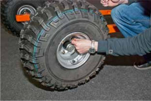
5. Montiere die Räder mit den mitgelieferten **M12 Radmuttern**. Achte darauf, dass die konische Seite der Mutter zur Felge zeigt.
