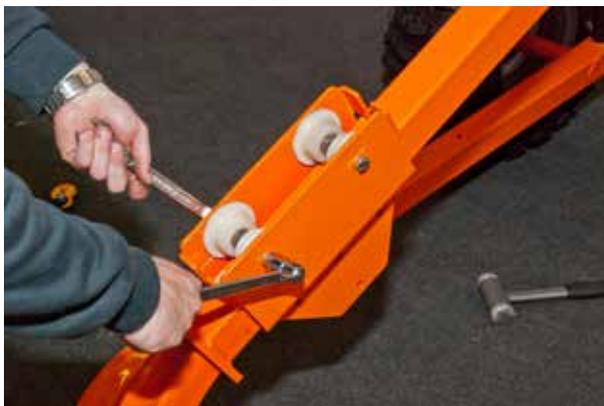
10. Baue die Seitenteile des Gleitschlittens inkl. Rollen zusammen. **2 x M10 x 100 + M10 Kontermutter** und **M10 Unterlegscheiben** sowie **3 x M10x25 + M10 Kontermutter** und **M10 Unterlegscheiben**.
