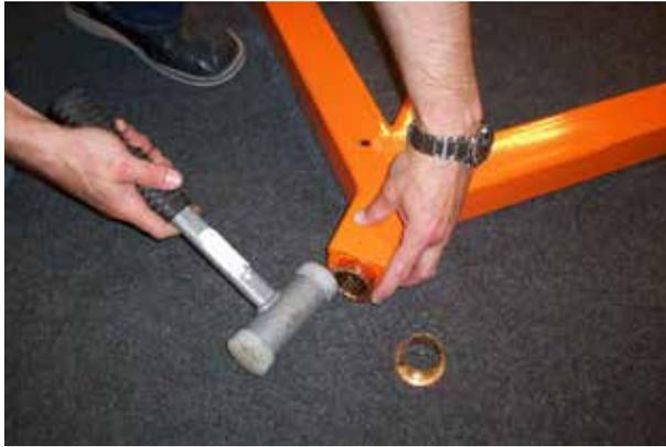
1. Beginne mit der Montage der beiden Deichselbuchsen in der Rahmenfront. Eine auf jeder Seite. Verwende einen Gummihammer und bringe die Teile sorgfältig und vorsichtig in Position.
