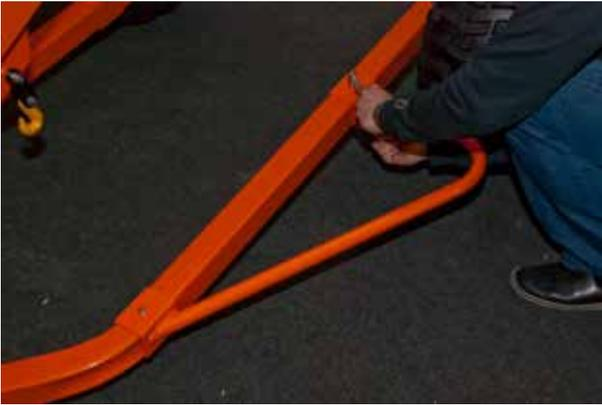
13. Befestige die Abweiser auf beiden Seiten des Rahmens wie dargestellt. Verwende **4 x M8x80** einschließlich **M8 Kontermutter** und **M8 Unterlegscheibe** auf der Seite der Mutter.
