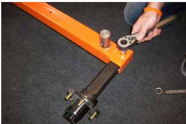
4. Setze die Radnaben in das quadratische Loch am hinteren Ende des Rahmens ein. Befestige sie mit einer **M12 x 60 + M12 Unterlegscheibe** sowie eine **M12 Mutter** (die Mutter kommt in das Sechskantloch auf der Unterseite des Rahmens). Ziehe die Schrauben fest an.
