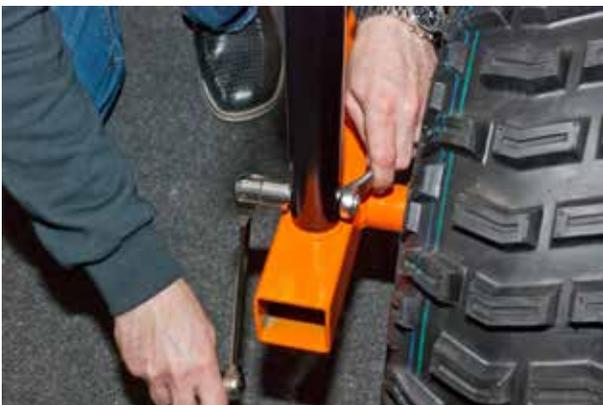
7. Schraube den Rohrbogen mit **2 x M10 x 60 + M10 Muttern und Unterlegscheiben M10** fest.
