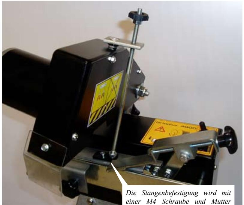
Die Stangenbefestigung wird mit einer M4 Schraube und Mutter befestigt. Die Schraube führt durch die Nut in der Stangenbefestigung.
