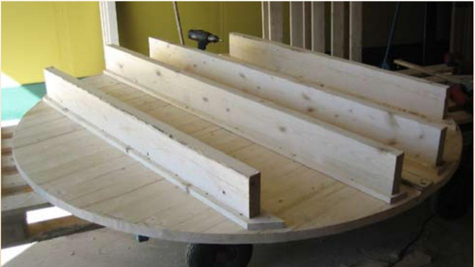
Die Fixierbretter und die Boden- Unterzüge sind miteinander zu T- Balken verbunden, die dann an den Boden geschraubt werden. Die Ende berührt die 20 mm- Linie.
