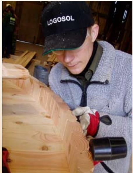
*Die Seitenbretter werden mit einem Gummihammer angepasst, bis der Abstand zwischen der 10mm- Linie und den Brettern um die ganze Badewanne herum gleich ist.*
