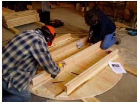
*Die T- Balken werden an den Boden geschraubt.*
