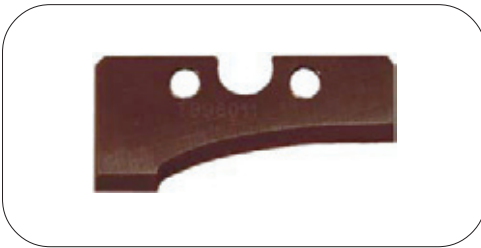
96011HSS Stammprofilpaneele (Schwedenpaneele) zusammen mit 95051. Profiltiefe: 10mm
