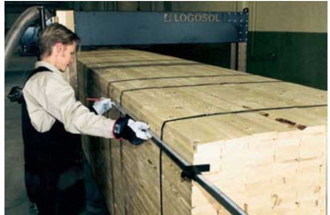
Ansschlag an die Schnittfläche anlegen und die neue Sägelinie oben und unten an beiden Seiten des Holzstapels anreißen.
