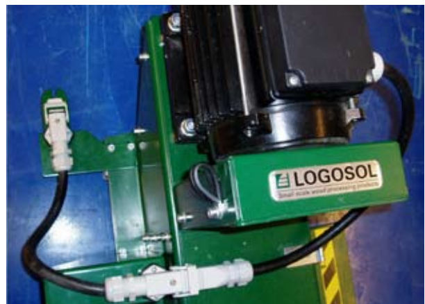
Das Kabel der Blockholzfräse mit einem zusätzlichen Stecker als Sicherheitsmaßnahme über der Abdeckung angebracht.
